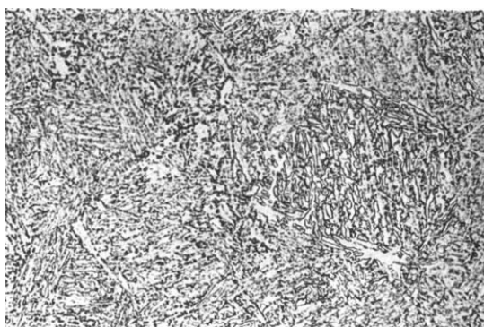
Kohlenstoffstahl mit Sorbitischem Gefüge 500x
