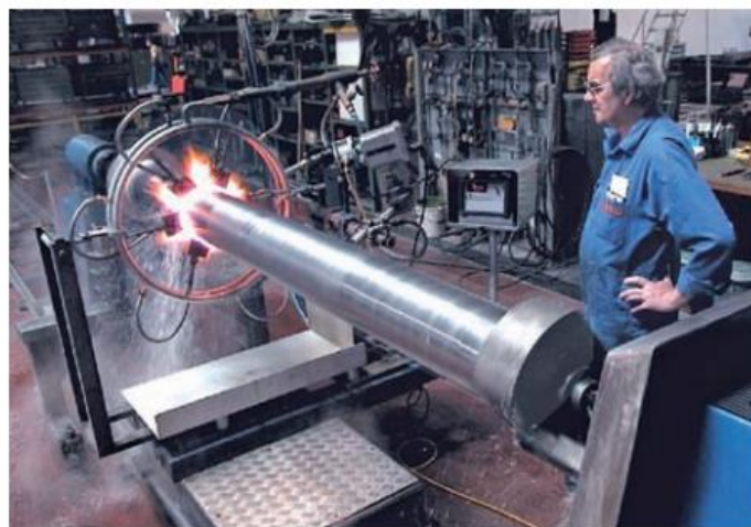
Bild 21: Flammhärten einer Kolbenstange für einen Schiffdieselmotor
