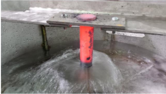
Stirnabschreckversuch nach Jominy: DIN EN ISO 642
